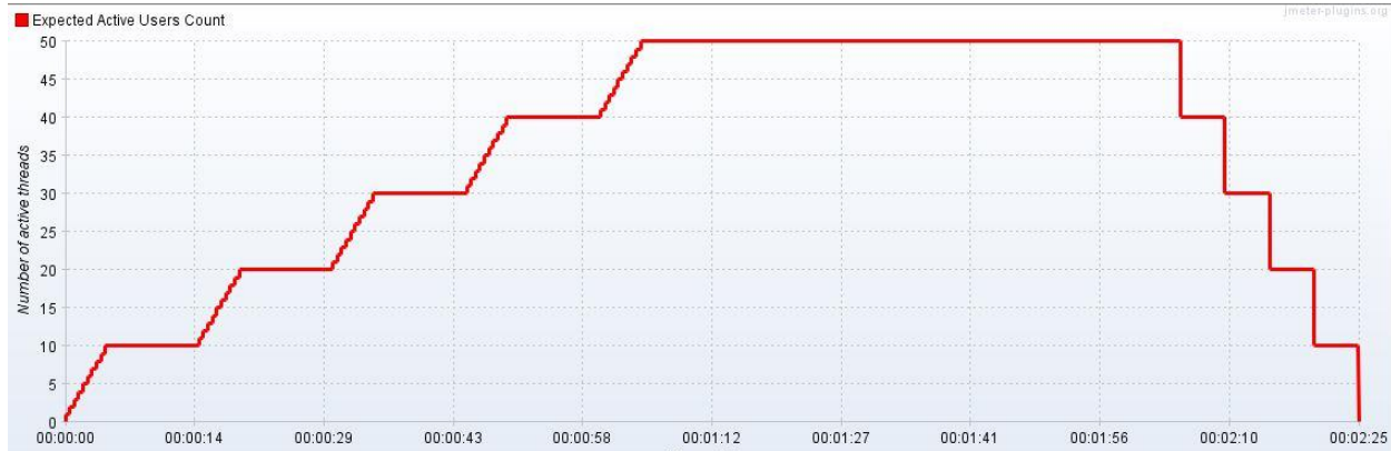
Figuur 59 : De geteste userload, om de 10 seconden starten er 10 nieuwe threads tot een maximum van 50 threads waarna het na een minuut snel terug daalt.
