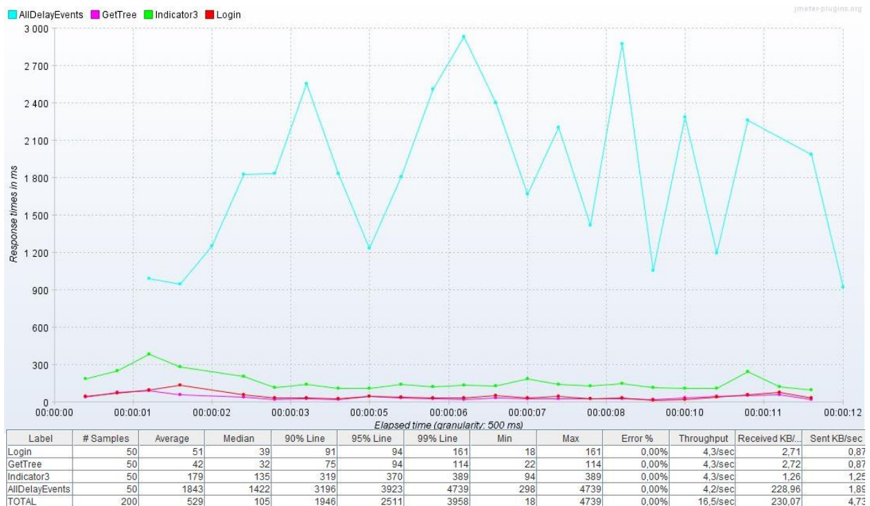
Figuur 58: Resultaten van de load test. X-as: Tijd, Y-as: Response time.
